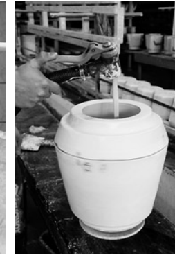
01 Das Gipsmodell des ersten Lampenschirms wird auf der Gips-scheibe gedreht. The plaster model of the first lampshade is turned on the wheel.
