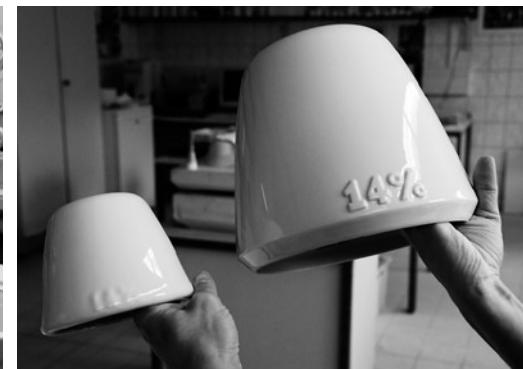
05 Vom gebrannten Porzellanschirm wird erneut eine Gipsform hergestellt. A new plaster form is made from the fired porcelain shade.
